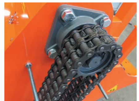
Mechanischer Antrieb über Duplex-Kette
