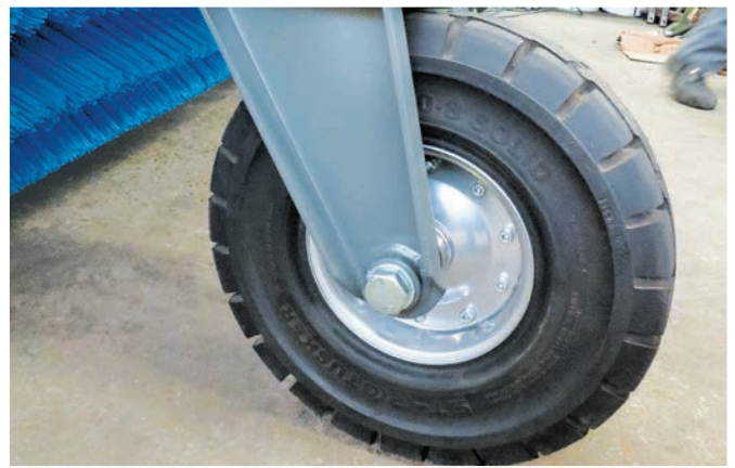
Stabile Super-Elastik-Vollgummiräder Ø 446 x 122 mm mit verstärkter Felge (4 mm)
