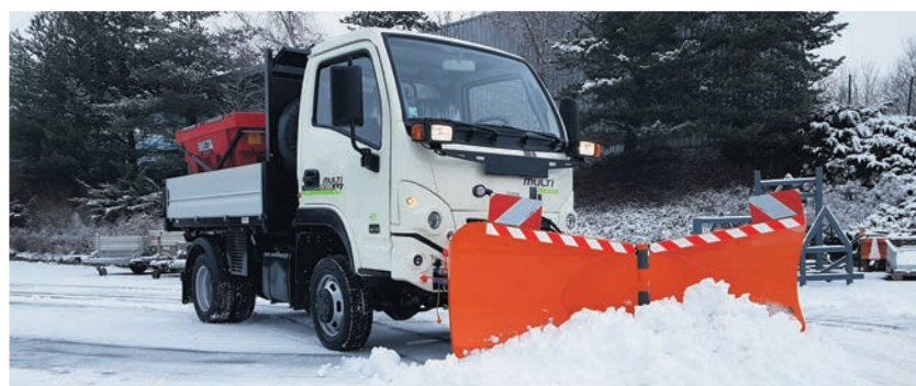
bema V-Schild V800 am Kommunalfahrzeug
