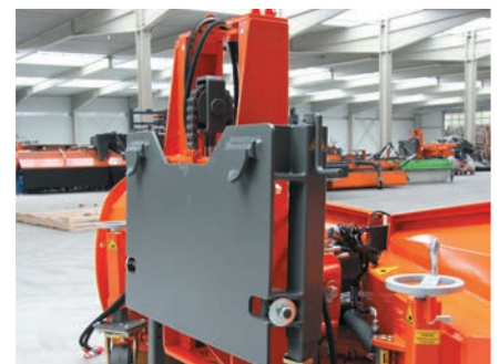
bema Lifter für LKW-Anbau
