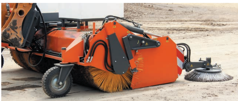
bema Titan Dual am Radlader mit Seitenkehrbesen und Wassersprüheinrichtung
