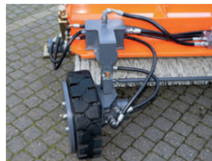
Effizienter - lenkbarer Radantrieb (hydraulisch)
