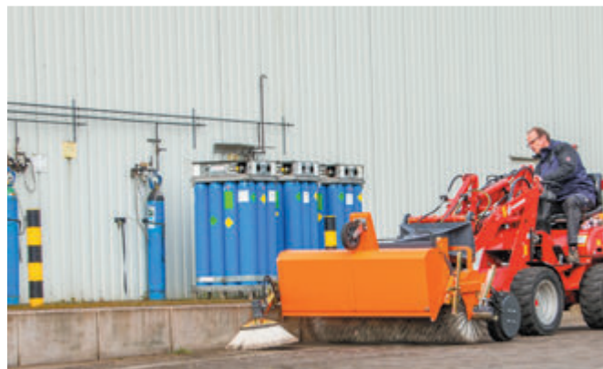
Schmutzsammelwanne im bewährten Dual-System, z. B. Freikehren bei geöffneten Schmutzsammelwanne
