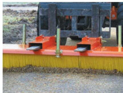
Palettenaufnahme mit werkzeugloser Arretierung
