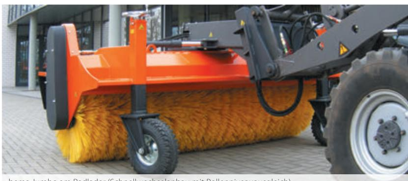
bema Jumbo am Radlader (Schnellwechselanbau mit Rollenniveaueausgleich)
