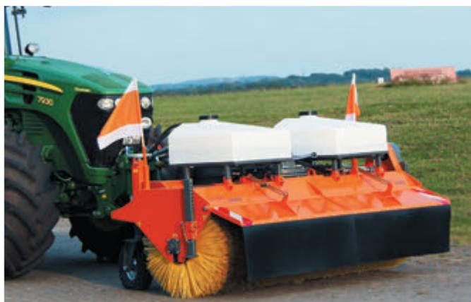
bema Jumbo angebaut am Schlepper (Front)
