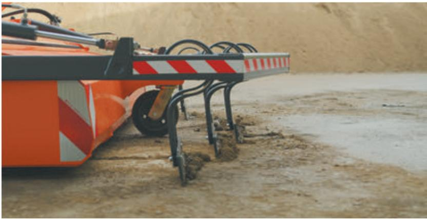
Aufkratzschiene unterteilt in Hardoxsegmente
