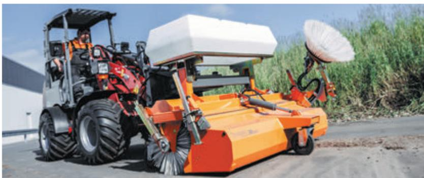
bema 20 Dual mit Wassersprüheinrichtung und Seitenkehrbesen
