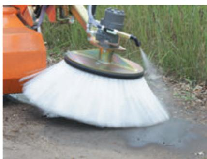
Seitenkehrbesen mit Wassersprüheinrichtung
