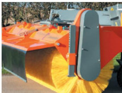
Kettenkasten (seitlicher Kettenantrieb)
