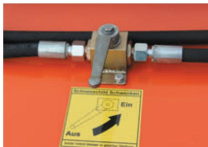
Absperrhahn zum Verriegeln des
