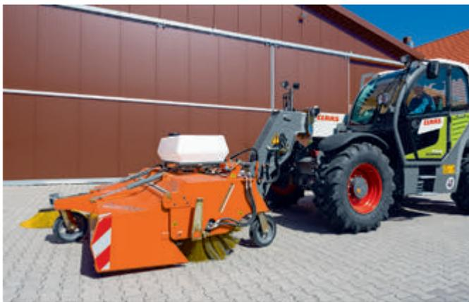
bema 75 Dual PowerMaster am Teleskoplader Schnellwechselanbau
