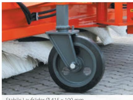
Stabile Laufäder Ø 415 x 100 mm, Gussfelge mit Radlager
