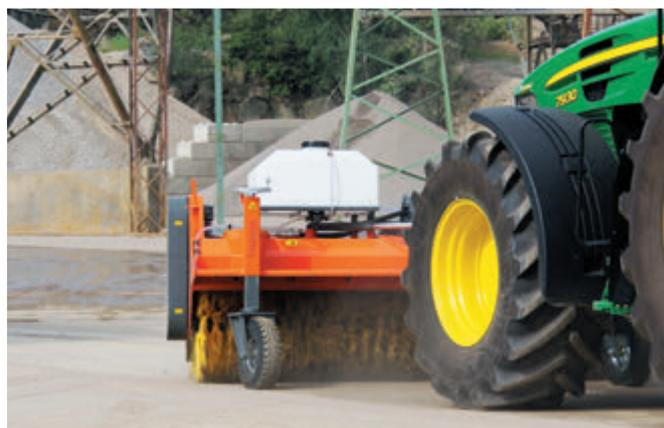
bema Jumbo angebaut am Schlepper (Front)
