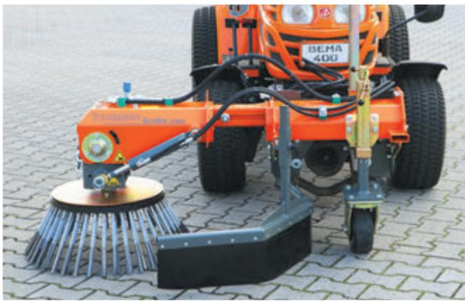
Flexibel dank der teleskopierbaren seitlichen Verschiebung (300 mm)
