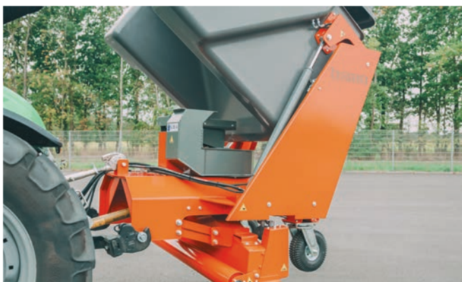
Komplette Heckeinheit bestehend aus bema Saug-Kehrdüse, Häckselgebläse und bema Kippcontainer
