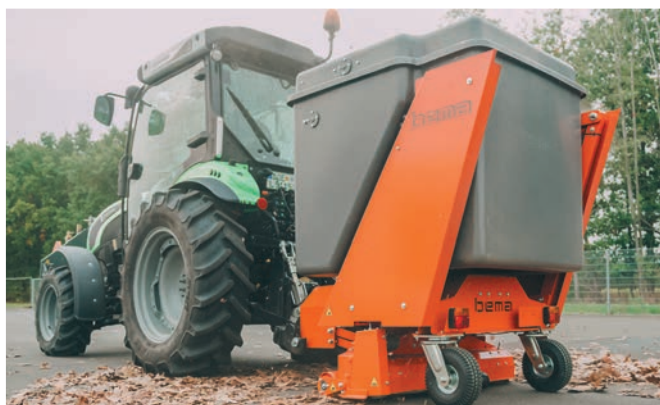
Schnell einsatzbereit - die komplette Heckeinheit, Anbau über Dreipunktbock Kat I/II
