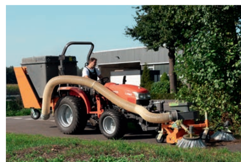
bema Saug-Kehrdüse inkl. Häckselgebläse und im Heck der neue bema Kippcontainer
