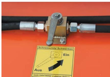
Absperrhahn zum Verriegeln des hochgeklappten Schneeschildes
