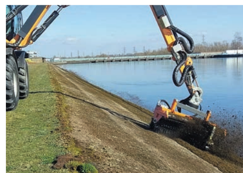
bema 25 mit Wildkrautbürste, Anbau Bagger (Sonderbau)
