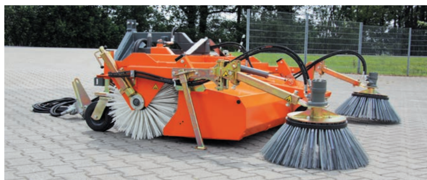
bema 25 Dual mit zwei Seitenkehrbesen - Wildkrautbesatz
