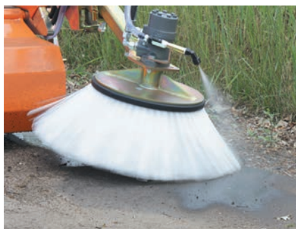
Seitenkehrbesen mit Wassersprüheinrichtung
