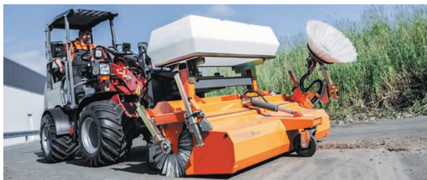
bema 20 Dual mit Wassersprüheinrichtung und Seitenkehrbesen
